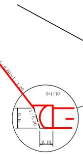
注: 法外配が2割より急な基礎地盤で、滑動のおそれのある基礎地盤は段切施工とする
